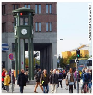
Figura 11: Réplica do primeiro semáforo de Berlim, de 1924, na Potsdamer Platz. Era uma torre de cinco lados, para as cinco aproximações, com uma cabine no alto para o policial operador. À direita, é possível ver um grupo focal de pedestres com a figura tradicional do Ampelmann.
