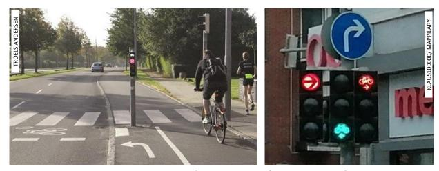
Figura 80: Esq. cruzamento em T, em que o ciclista é livre para seguir em frente, mas usa grupo focal com seta para a travessia em Odense, Dinamarca. Dir: grupos focais veicular e de ciclista com seta em Dortmund, Alemanha.
