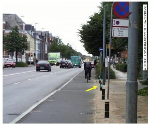
Figura 23: Balizadores piscam com a mesma velocidade da onda verde. Odense, Dinamarca.
