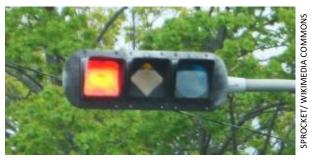
Figura 15: Moderno semáforo para daltônicos em Halifax, Canadá, com foco quadrado (vermelho), losango (amarelo) e circular (verde).
