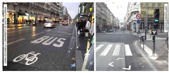
Figura 148: Exemplos na França: faixa compartilhada entre ônibus e bicicleta em Paris (esq.) e faixa compartilhada no contrafluxo com grupo focal de ônibus e de bicicleta em Lyon.
