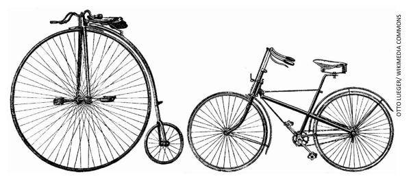
Figura 132: Comparação entre uma penny-farthing de 1880 e uma bicicleta de segurança de 1886.
