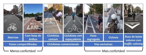
Figura 28: Graus de conforto para diferentes tipos de vias cicláveis. [Fonte: BOSTON (Cidade)]
