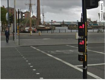
Figura 89: Travessia toucan. Modelo com um foco de ciclista no Reino Unido em Edimburgo (esq.) e com dois focos e dois grupos focais em Liverpool. Na parte inferior é possível ver a botoeira.
