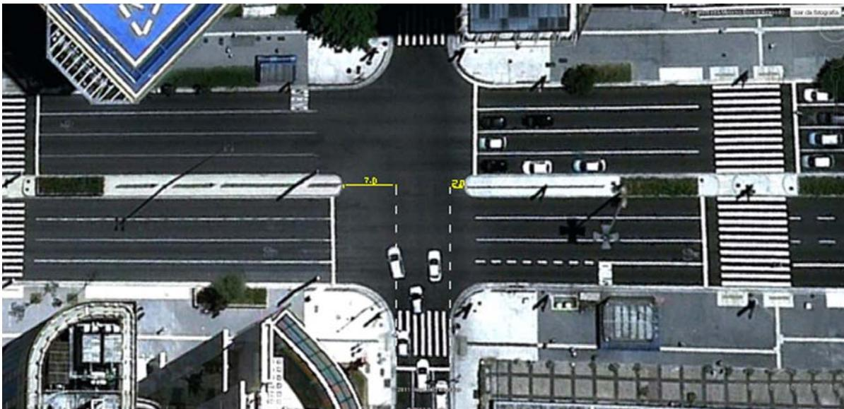
**FOTO 16** - Visão da reconfiguração dos raios de giro para transversal.
